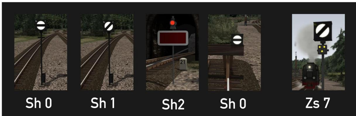
Neben- oder Abstellgleise, die nicht durch Hauptsignale bedient werden, sind mit Schutzsignalen ausgestattet, die zwei mögliche Stellungen haben: Sh 0 - Halt oder Sh1 – Gleissperre aufgehoben. Wir finden das Signal Sh2 auf Abstellgleisen, die nicht oder nur unter bestimmten Umständen verwendet werden können, z. B. an Anschlüssen zu Werken oder Gleisen, die aufgrund von Wartungsarbeiten vorübergehend außer Betrieb sind. Sh 0 wird auch als Abschließsignal bei Prellböcken verwendet.
